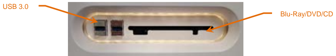
Hình 12-8: Bảng điều khiển đa phương tiện di động của Hệ Thống Chụp Chiếu Nội Mạch Makoto™
